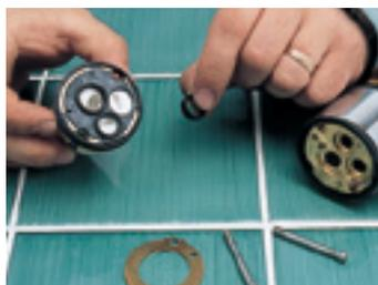
*En rangeant les différentes pièces du robinet dans l'ordre de démontage, on facilite le remontage.*
